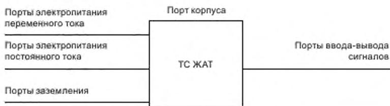
Рисунок 1 — Примеры портов ТС ЖАТ
