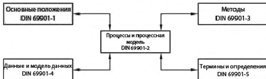
Рисунок 1 – Взаимосвязи между отдельными частями DIN 69901
