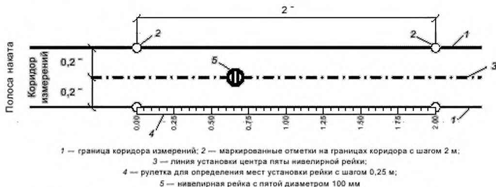
Рисунок А.1 — Схема разметки коридора измерений при нивелировании тестового участка
