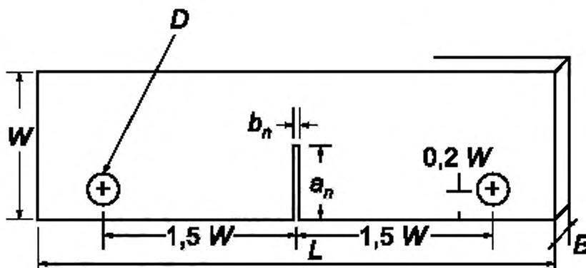
$D$  — диаметр отверстия для крепления;  $W$  — ширина образца;  $b_n$  — ширина предварительно нанесенной усталостной трещины (надреза);  $a_n$  — длина предварительно нанесенной усталостной трещины (надреза);
