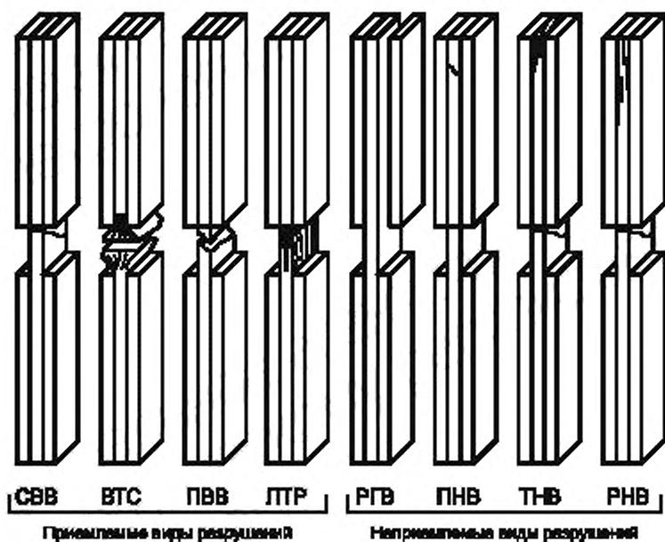
Рисунок 3 — Примеры обозначения типовых разрушений
