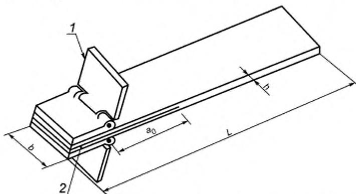
1 — ось шарнира летки; 2 — вставка;  $a_0$  — начальная длина трещины;  $b$  — ширина образца;  $L$  — длина образца;  $h$  — толщина образца
