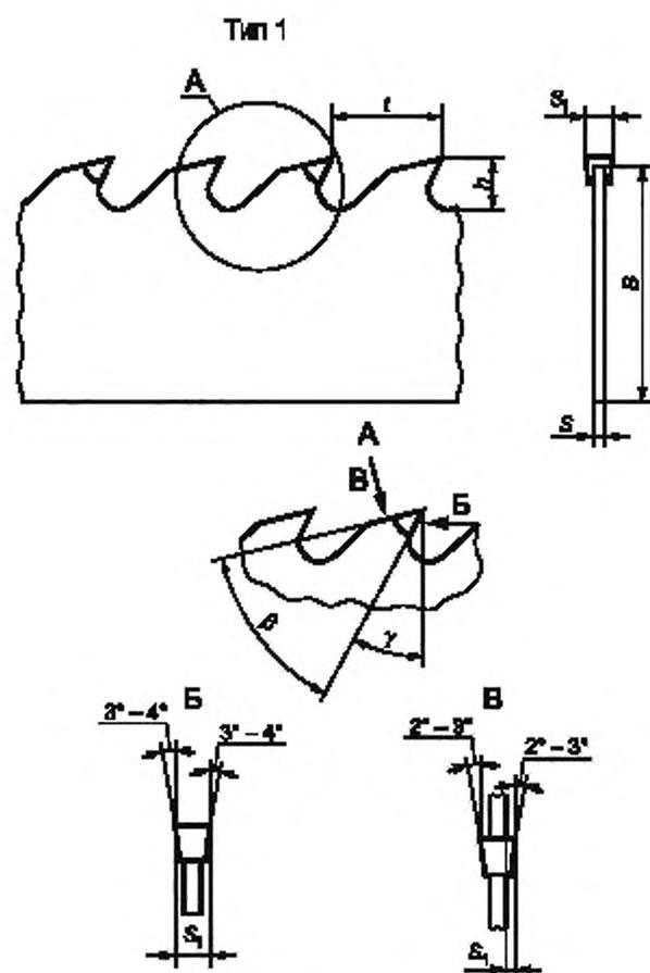
Примечание — Наплавка стеллита через зуб
