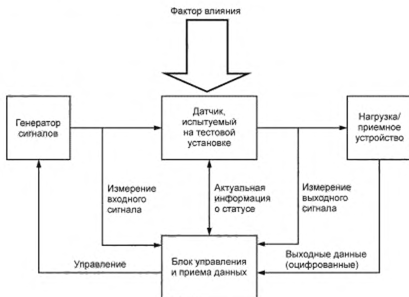
Рисунок 2 — Базисная схема установки для проведения тестовых испытаний
