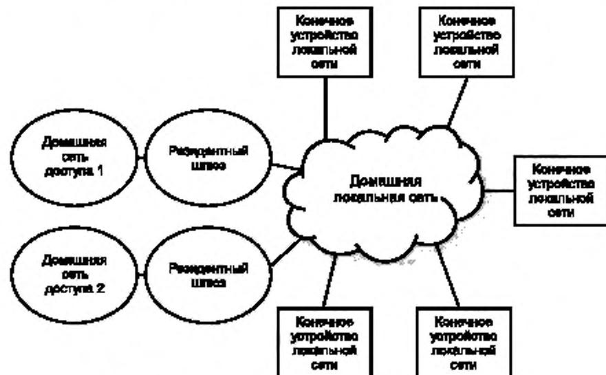
Рисунок 2 — Структурная схема модели домашней локальной сети
