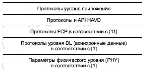
Рисунок 5 — Стек протоколов потока S2 HLN
