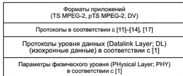
Рисунок 4 — Стек протоколов потока S1 HLN
