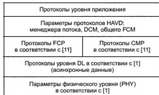
Рисунок 6 — Стек протоколов потока S4 HLN
