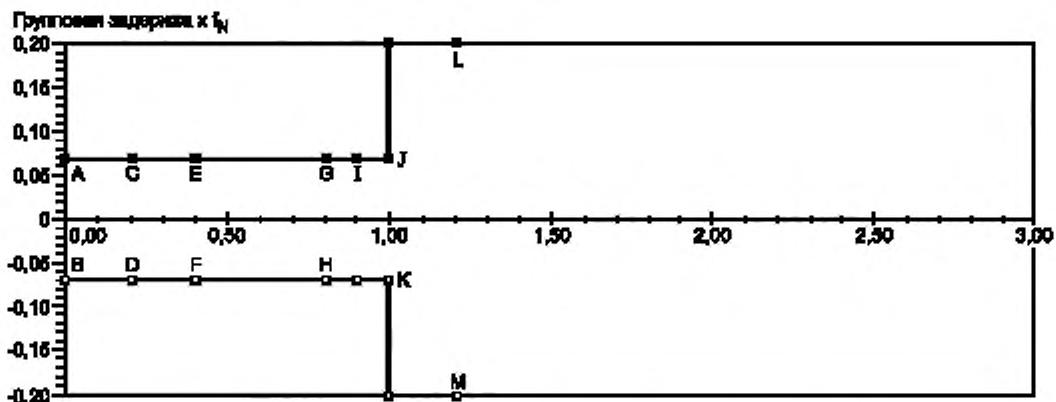
Рисунок А.2 — Мaska для характеристики групповой задержки модулятора CID, эквивалентной характеристике групповой задержки фильтра Найквиста
