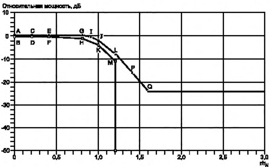
Рисунок А.1 — Мaska АЧХ модулятора CID, эквивалентная АЧХ фильтра Найквиста
