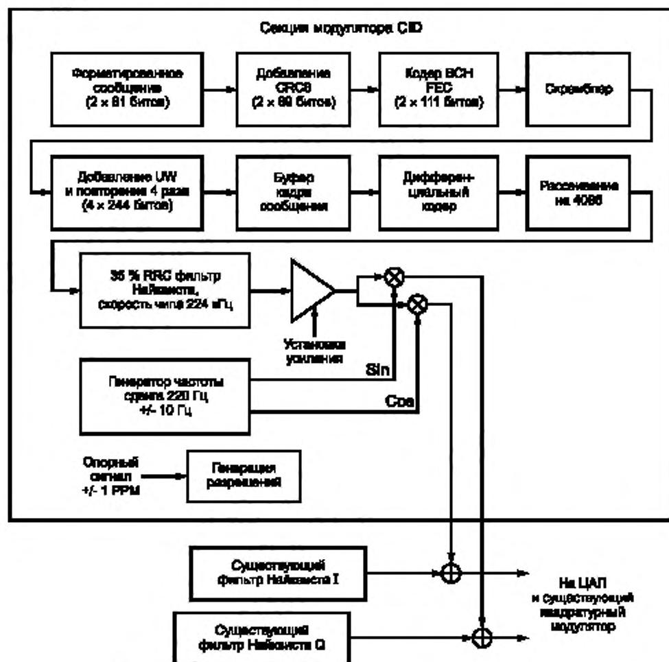
Рисунок 1 — Пример структурной схемы передатчика с функцией CID
