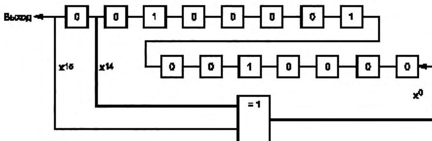
Рисунок 6 — Структурная схема генератора рассеивающей последовательности
