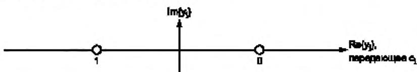
Рисунок 7 — Отображение ячейки на диаграмму созвездия BPSK
