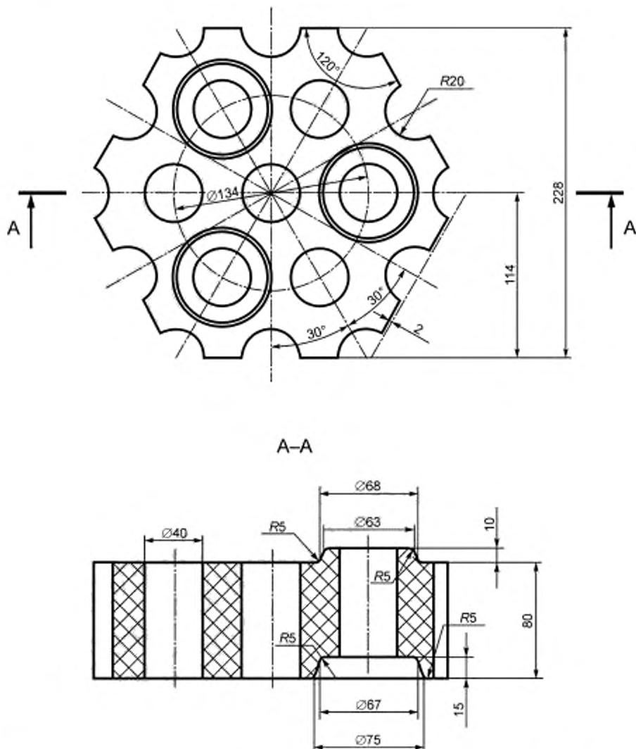
Примечание — Допускается по согласованию сторон изготавливать изделия толщиной 120, 160 мм и более.
