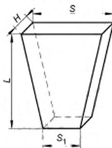
Рисунок 2 — Трапецидальный двусторонний клин (стенное изделие)
