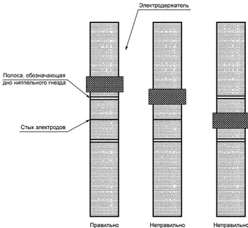
Рисунок 11 — Схема зажима электродов в электрододержателе
