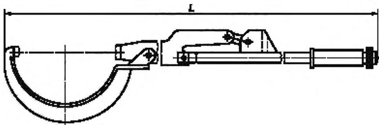
Рисунок 9 — Ручной зажим с ограничителем врачающего момента
