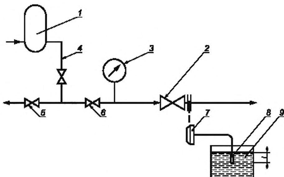
1 — источник сжатого воздуха; 2 — испытуемая ТПА; 3 — прибор для измерения давления; 4, 5, 6 — запорно-регулирующий клапан, 7 — заглушка с трубкой, 8 — насадка, 9 — емкость с водой;  $l$  — расстояние между выпускным концом насадки и поверхностью воды
