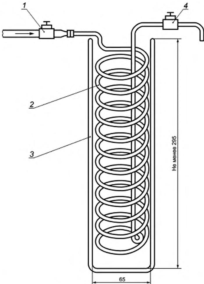
1 — правоотборный клапан диаметром 6 мм; 2 — змеевик из медной трубы длиной 6 м, наружным диаметром 5 мм; 3 — металлический или стеклянный охлаждающий сосуд; 4 — игольчатый клапан диаметром 3 мм
