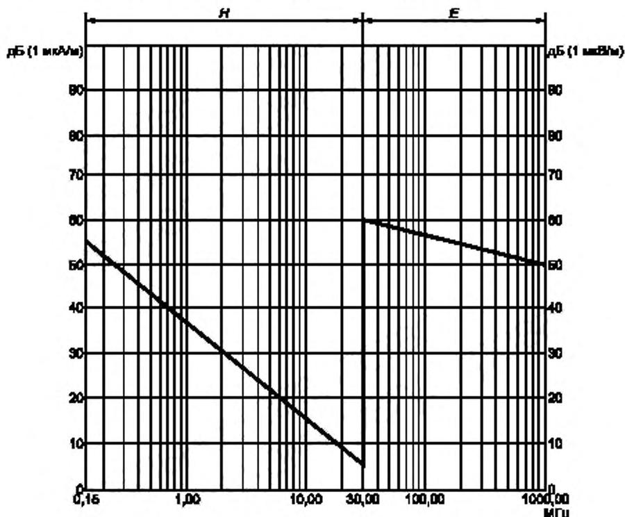
Рисунок 2 — Нормы напряженности поля электромагнитных помех (квазициковые значения) от тяговых подстанций
