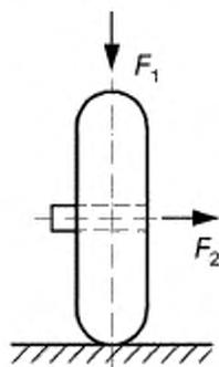
$F_1$  — сосредоточенная вертикальная нагрузка,  $F_2$  — трение сцепления ролика
