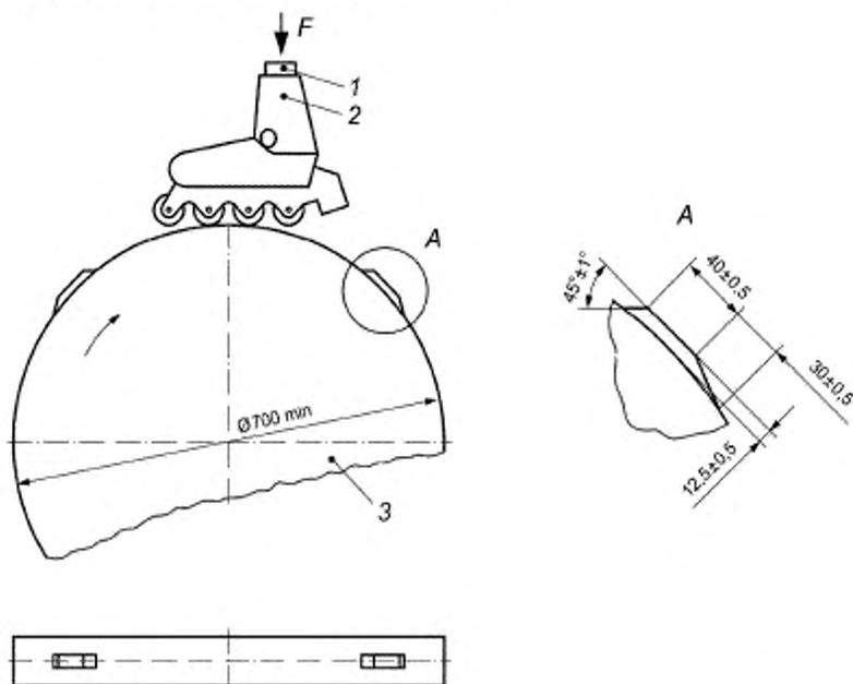
1 — колodka; 2 — роликовый конек; 3 — испытательный цилиндр с выступами
