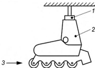
1 — колодка; 2 — роликовый конек; 3 — направление удара
