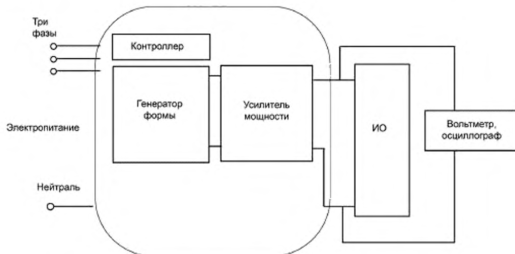
Рисунок 3 — Схема однофазного испытательного оборудования с усилителем мощности
