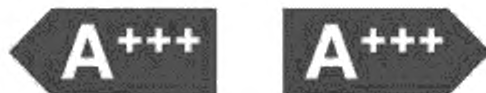
Рисунок Г.1 — Формат изображения, используемого для доступа к этикетке в случае вложенного экрана
