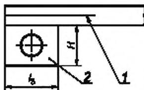
1 — образец; 2 — блок нагружения;  $H$  — высота блока нагружения;  $l_3$  — длина блока нагружения
