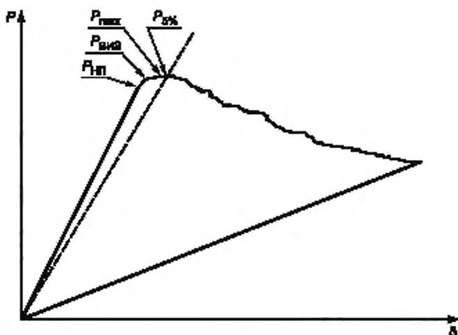
$P_{НЛ}$  — нагрузка начала отклонения диаграммы от линейной;  $P_{ВИЗ}$  — нагрузка в момент страгивания трещины (момент страгивания трещины определяется визуально);  $P_{max}$  — максимальная нагрузка на диаграмме;  $P_{5\%}$  — нагрузка в точке пересечения диаграммы и прямой, выходящей из начала координат, тангенс угла которой на 5 % меньше тангенса угла линейного участка диаграммы
