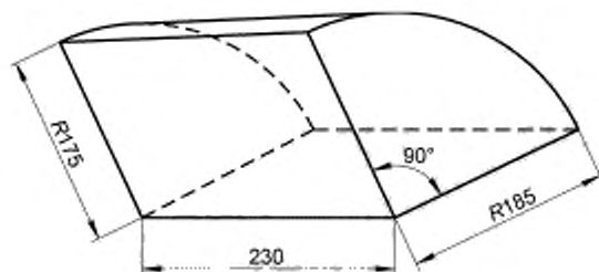
Рисунок 8 — Фасонное изделие номер 42 (для футеровки крышек сталеразливочных ковшей)
