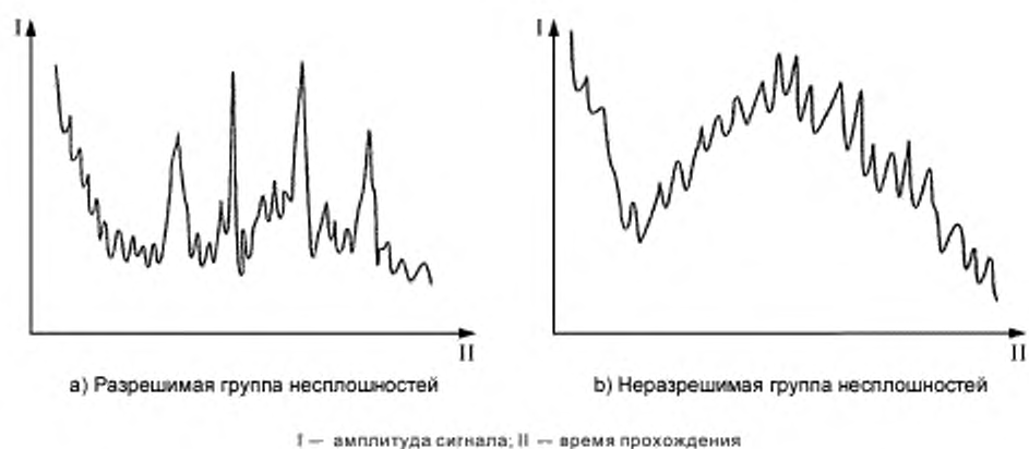
Рисунок 1 — Примеры сигналов с разверткой типа А из группы несплошностей в поковке или отливке
