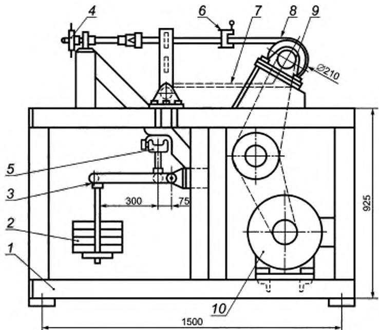
Рисунок В.1 — Стенд для испытания лент на воспламеняемость при трении на барабане
