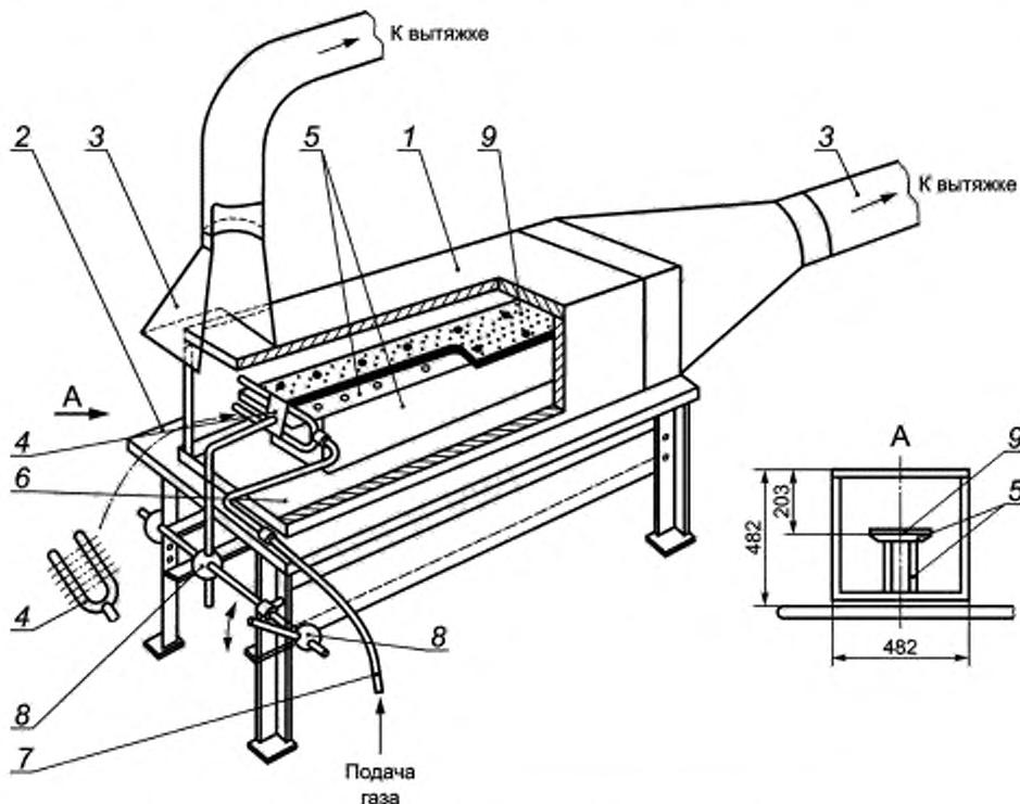
1 — камера горения; 2 — опорный стол; 3 — вытяжная труба с колпаком; 4 — газовая горелка;
