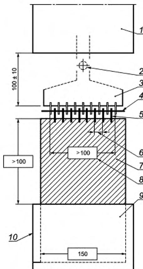
1 — зажимная клемма устройства проверки на растяжение; 2 — шарнир (по выбору); 3 — гребень;
