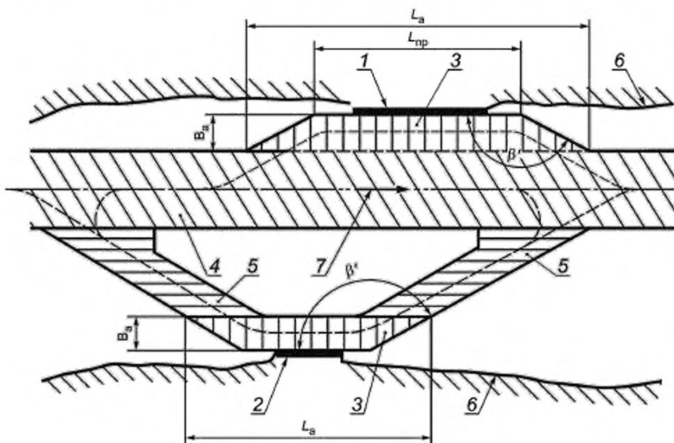
1 — причалы, расположенные в непосредственной близости от судового хода; 2 — причал, расположенный в стороне от судового хода; 3 — акватория причалов; 4 — транзитный или местный судовой ход; 5 — водные подходы к акватории причалов; 6 — береговая полоса; 7 — направление течения
