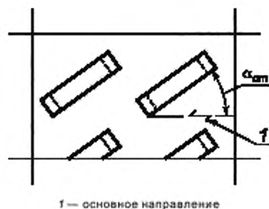
Рисунок 2 — Угол между направлением перекладины скобы и направлением волокон или основным направлением
