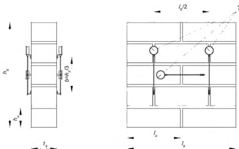
1 — приборы для измерения деформаций;  $b$  — база измерения деформаций;  $h_s$  — высота образца;  $h_u$  — высота кладочного изделия;  $t_s$  — толщина образца;  $t_u$  — толщина кладочного изделия;  $l_s$  — длина образца;  $l_u$  — длина кладочного изделия
