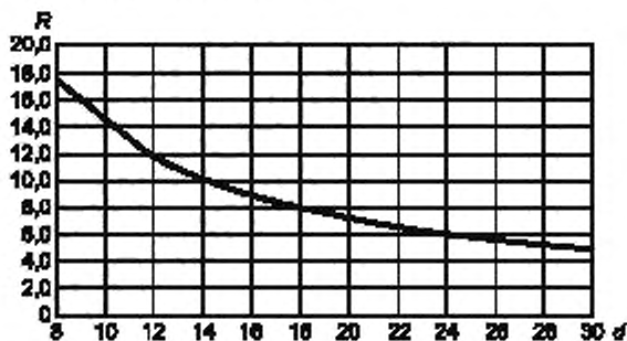
Рисунок 4 — Зависимость угла поворота от диаметра крепления
