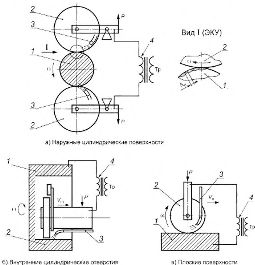
$P$  — усилие прижатия роликового электрода к детали;  $V_{пр}$  — скорость продольного перемещения роликового электрода;
