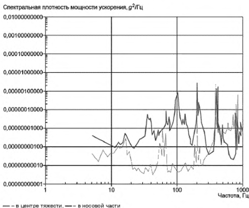
Рисунок 2 — Измерение собственного шума измерительной системы самолета Tristar
