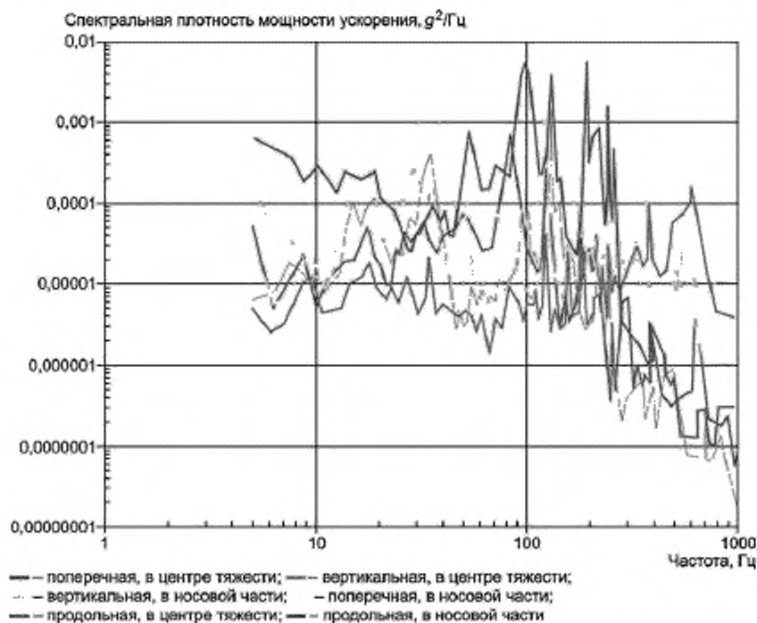
Рисунок 3 — Измерения вибрации на самолете Tristar (режим 2 — см. таблицу 1)
