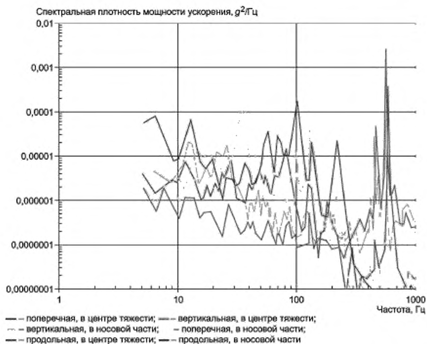
Рисунок 7 — Измерения вибрации на самолете Tristar (режим 10 — см. таблицу 1)
