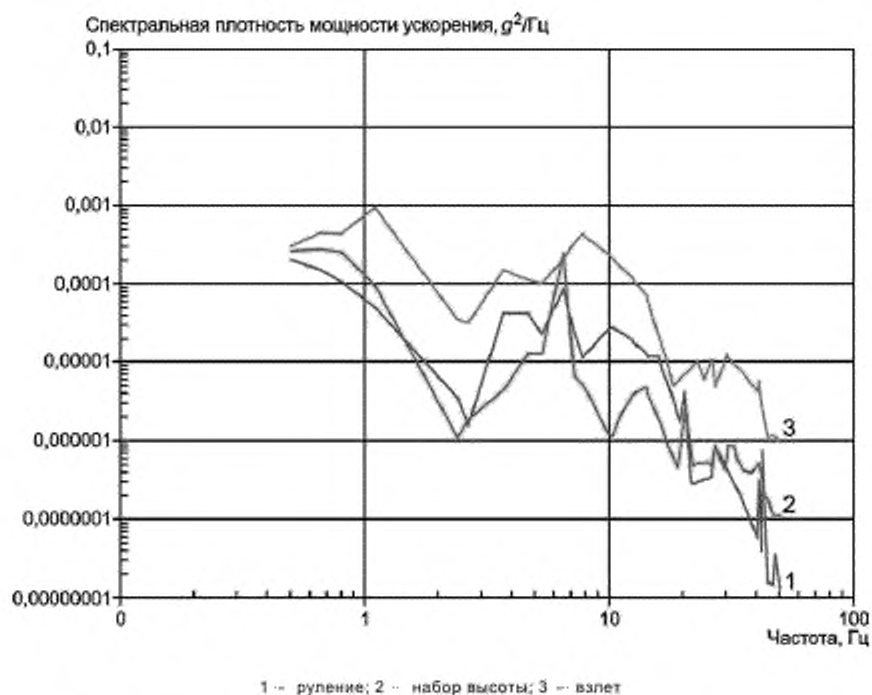
Рисунок 22 — Измерение V1 (см. таблицу 6) на поддоне самолета Boeing 747
