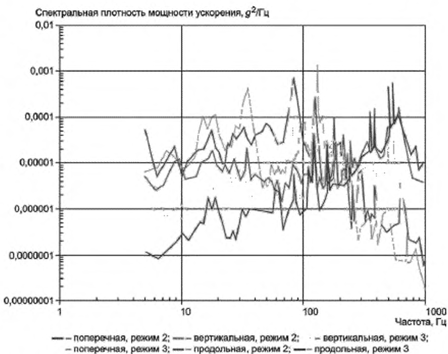
Рисунок 8 — Измерения вибрации на самолете Tristar (датчик в центре тяжести, взлет и набор высоты)
