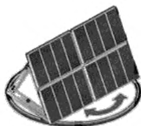
Рисунок 2 — Пример одноосной системы слежения за Солнцем с вертикальной осью вращения
