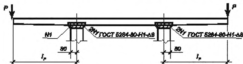
Рисунок 5 — Схема испытания ступеней типоразмера ЛСС 24
