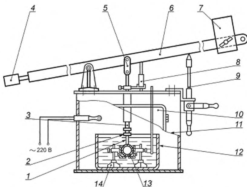
1 — стержень; 2 — гайка; 3 — оправа; 4 — верньер; 5 — серьга; 6 — рычажное устройство; 7 — груз; 8 — индикатор;
