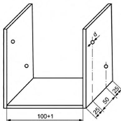
$d$  — диаметр отверстия, равный диаметру концевой части концентратора с отклонением  $+0,5$  мм
