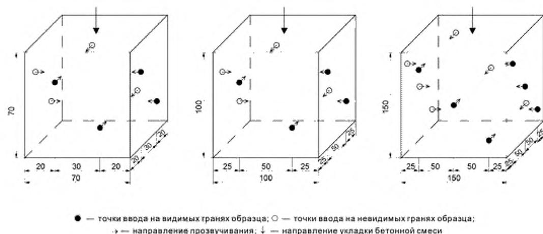
Рисунок 1 — Схема расположения точек ввода ультразвуковых колебаний
