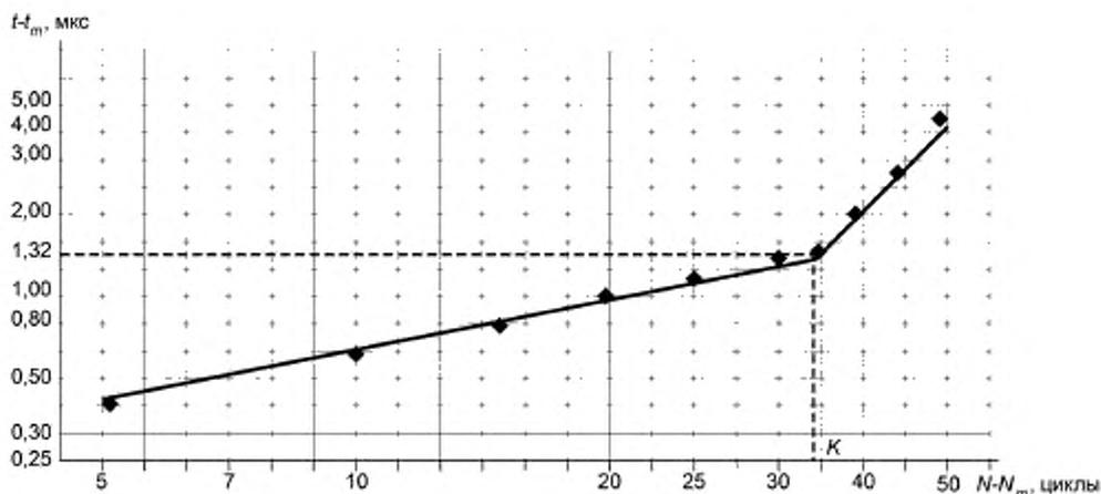
Рисунок Д.1 — График ультразвуковых измерений образца № 1
