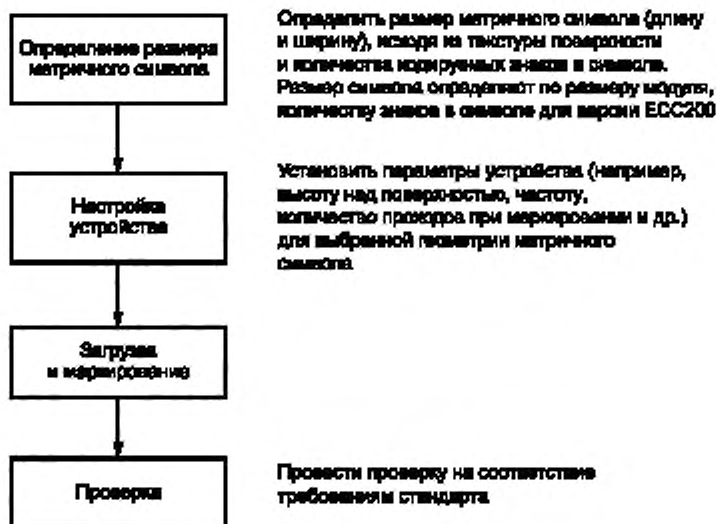
Рисунок 10 — Блок-схема определения параметров маркирования лазером
