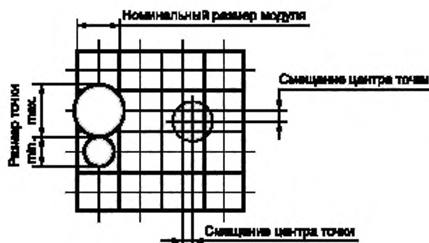
Рисунок 6 — Схема определения номинального размера модуля, смещения центра точки и размера точки
