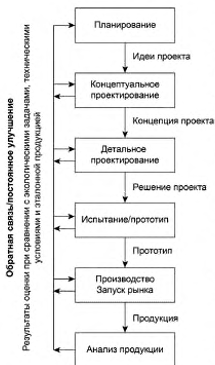
Рисунок 2 — Пример общей модели интегрирования экологических аспектов в процесс проектирования и разработки продукции
