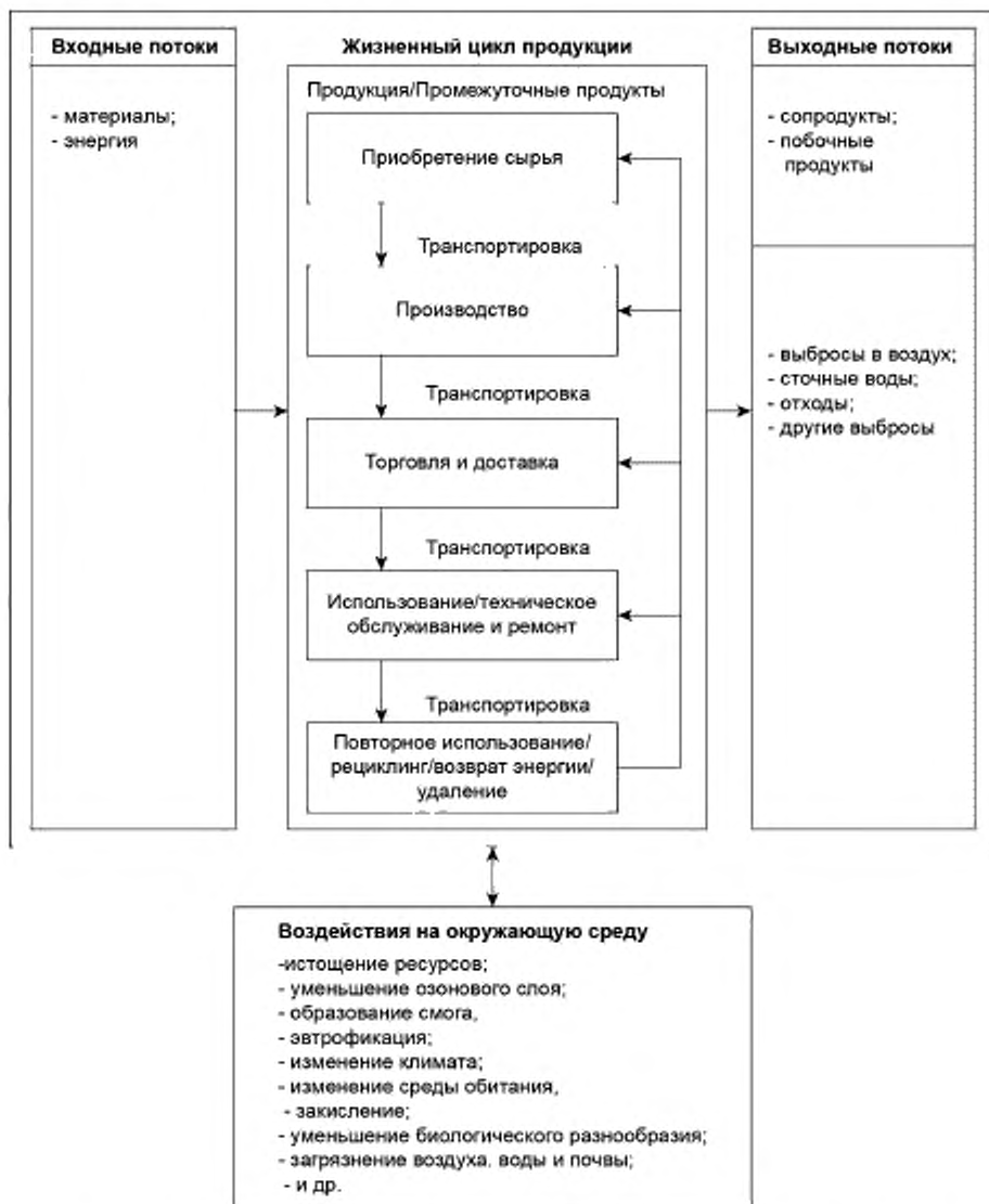
Рисунок 1 — Входные и выходные потоки и примеры воздействия на окружающую среду, связанные с жизненным циклом продукции
