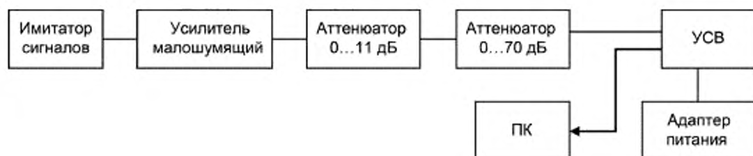
Рисунок В.3 — Схема определения чувствительности модуля ГНСС
