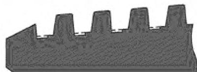
г) Подрез впадины витка резьбы
