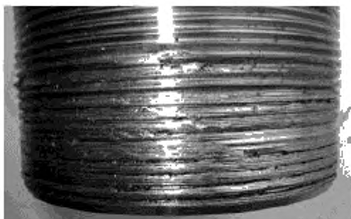
Рисунок 16 — Сорванные витки наружной резьбы
