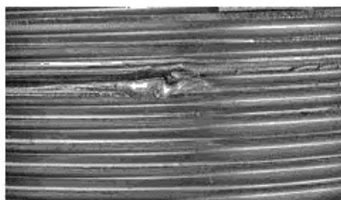
а) Рванина на витке наружной резьбы
