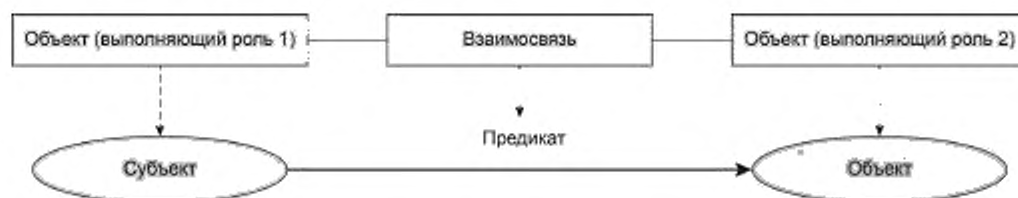
Рисунок 4 — Использование принципа RDF-триплетов для представления утверждений
