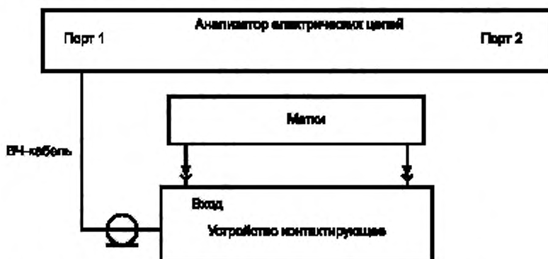
Рисунок 1 — Схема измерения электрических параметров меток в устройстве контактирующем
