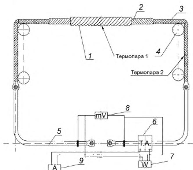
1 — наружный пояс спирального зажима; 2 — внутренний пояс спирального зажима; 3 — провод; 4 — изолирующие ролики; 5 — присоединительные кабели; 6 — трансформатор тока; 7 — ваттметр; 8 — милливольтметр; 9 — амперметр
