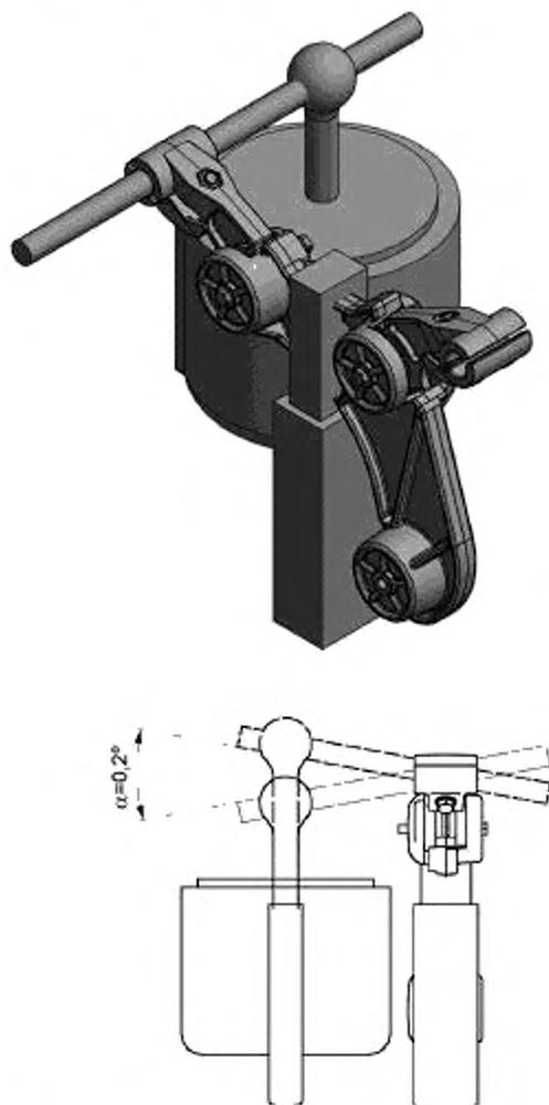
Рисунок 6 — Пример схемы испытаний на стойкость к вибрации
