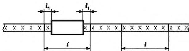
Рисунок 12 — Схема измерения сопротивления электрического контакта
