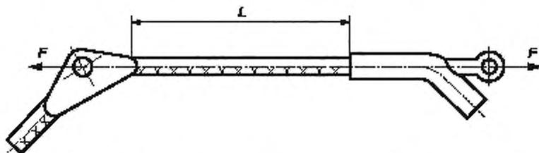
Рисунок 2 — Схема испытания прочности заделки в поддерживающих зажимах
