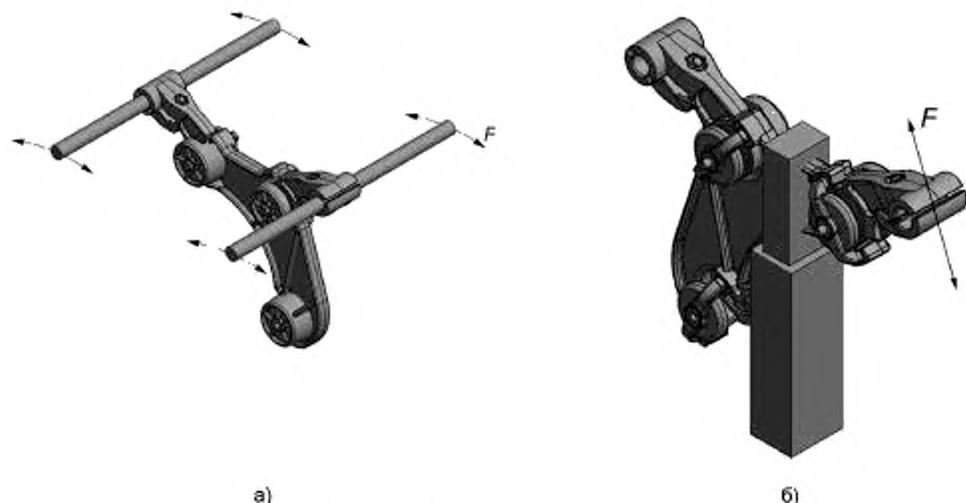
Рисунок 7 — Схемы испытаний распорки на стойкость к субколебаниям
