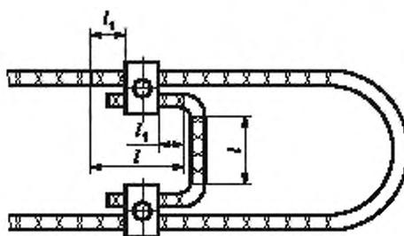
Рисунок 13 — Схема измерения сопротивления электрического контакта ответвительной арматуры
