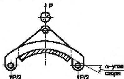
Рисунок 4 — Схема испытания разрушающей нагрузкой поддерживающих зажимов
