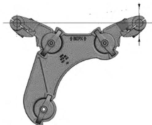
Рисунок 9 — Схема испытаний на вертикальное смещение.
