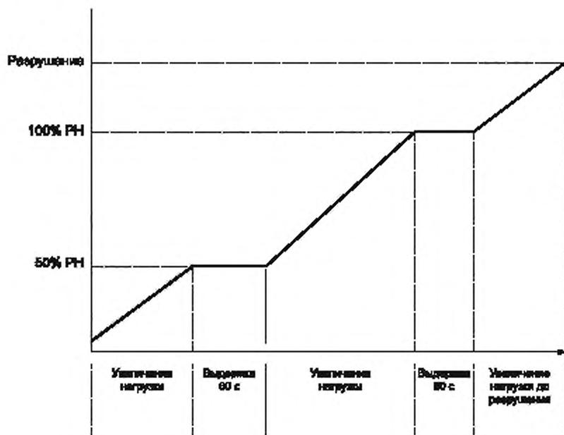
Рисунок 3 — Механическое испытание при разрушающей нагрузке (РН)
