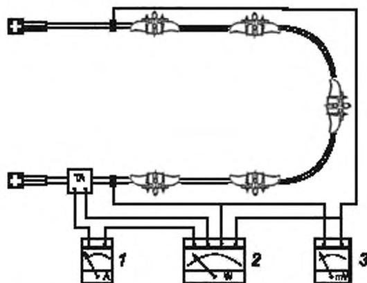
1 — амперметр; 2 — ваттметр; 3 — милливольтметр
