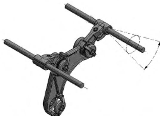
Рисунок 10 — Схема испытаний на коническое смещение
