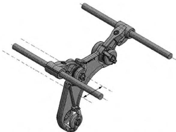
Рисунок 11 — Схема испытаний на горизонтальное поперечное смещение
