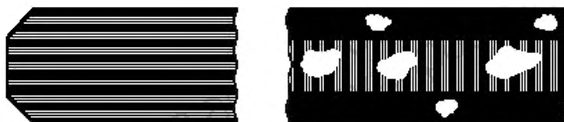
Рисунок А.2 — Грубо шлифованная кромка
