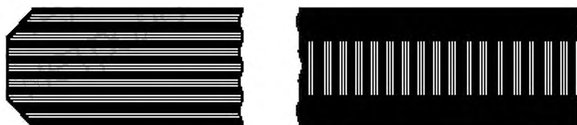
Рисунок А.3 — Гладко шлифованная кромка
