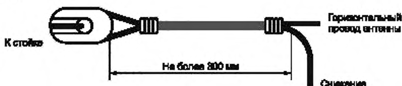
Рисунок 5.1 — Сопряжение снижения и горизонтального провода антенны
