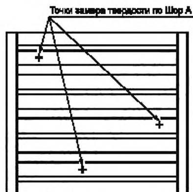
Рисунок 3 — Определение твердости по Шору А
