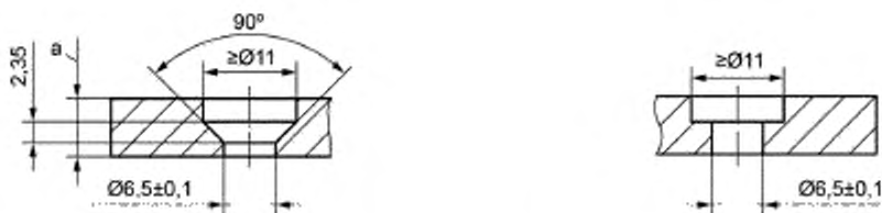
а) для винтов с потайными головками
