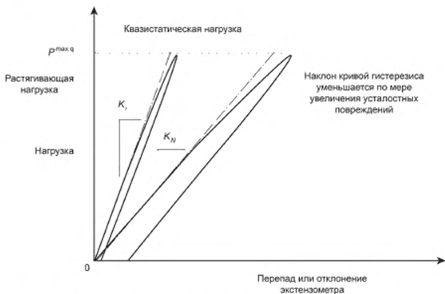
Рисунок 1 — Типичные графики зависимости растягивающего усилия от отклонения с изображением формы и параметров кривой гистерезиса
