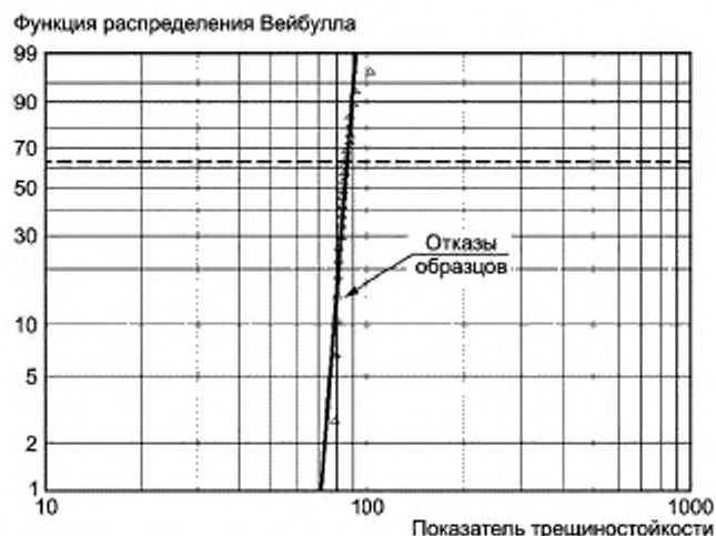
Рисунок Н.1 — Испытания на разрыв стальной пластины
