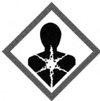
Рисунок 3 — Пиктограмма «орган—мишень» при многократном токсическом воздействии для повторяемой дозы 1-го уровня при присутствии порошка оксида кремния в концентрации выше 1 % масс.
