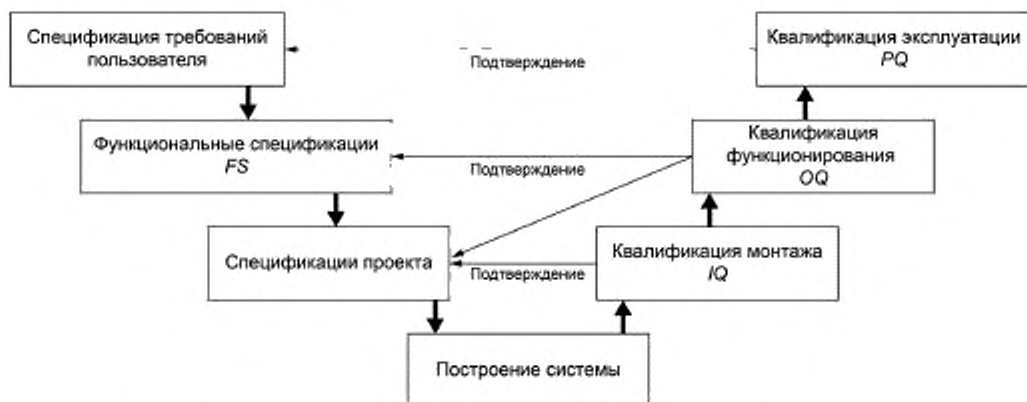
Рисунок 2 — Примерная схема взаимосвязи между ключевыми спецификациями и этапами квалификации в процессе проектирования, построения и тестирования системы 2)
