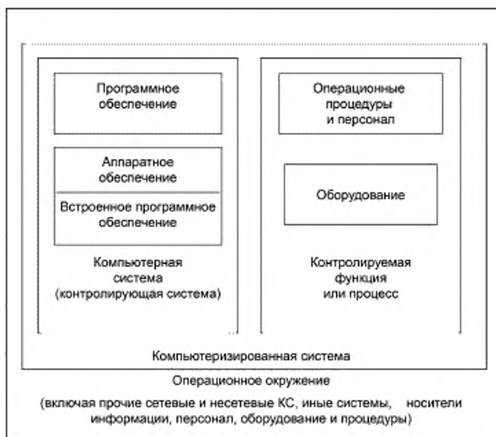
Рисунок 1 — Схема взаимодействия различных компонентов КС в ее операционном окружении
