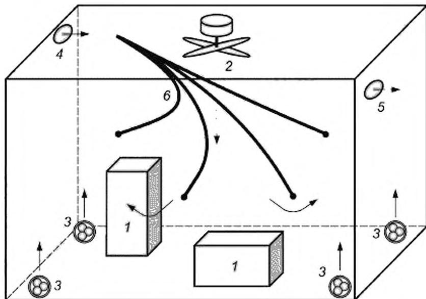
1 — испытуемые образцы; 2 — основной вентилятор; 3 — дополнительные вентиляторы; 4 — входной штуцер,
