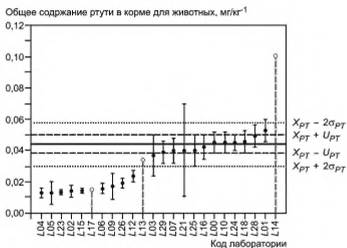
Рисунок Е.5 — Результаты участников и соответствующие неопределенности при определении концентрации ИМЕР 111 (данные таблицы Е.6)
