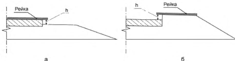
Рисунок 1 — Схема измерения величины занижения (возвышение) обочины и разделительной полосы:
